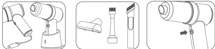
\*Для зарядки рекомендуется использовать адаптер 5В 2А / автомобильное зарядное устройство, причем адаптер питания не идет в комплекте.
